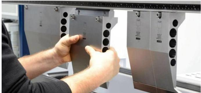
Figura 36.- Sujeción de útil automática (Fuente: Trumpf).
