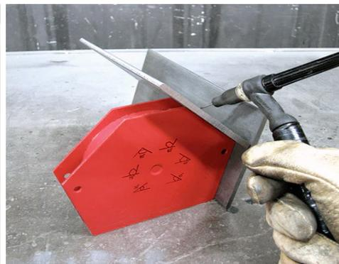
Figura 47.- Sistema de fijación y soportes magnéticos en escuadra (Fuentes: Förster, Master Magnetics USA, Assfalg GmbH).
