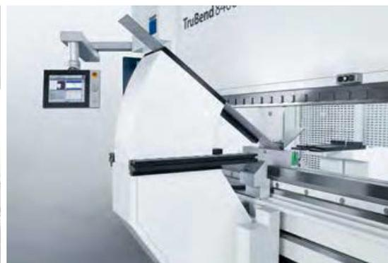
Figura 38.- Dispositivo de asistencia de plegado hidráulico (Fuentes: Safan-Darley, Trumpf).
