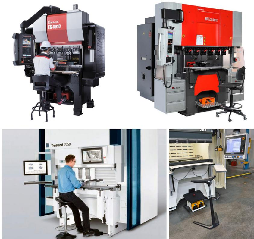
Figura 39.- Plegadoras comerciales que permiten el trabajo sentado o con apoyo de pie (Fuentes: Amada, Gasparini, Trumpf).
