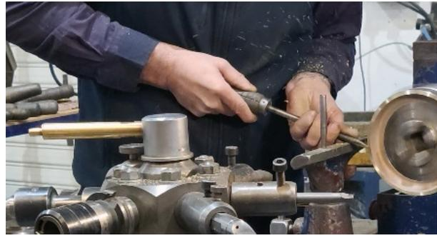
Figura 33.- Apoyo para trabajo con herramientas manuales (Fuente: estudio de campo).
