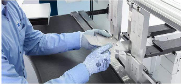
Figura 35.- Soporte para brazos ajustable (Fuente: Trumpf).
